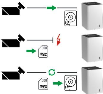
Die Funktion ANR dient zur unterbrechungsfreien Aufzeichnung, wenn die Verbindung zur Kamera unterbrochen wird.
